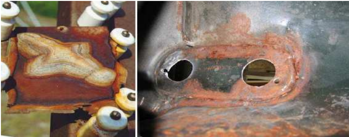
Şekil 2.25 Farklı görünümelerde aralık korozyonları
