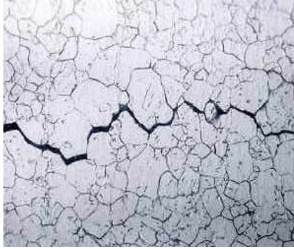
Şekil 2.17 Taneler arası korozyon
