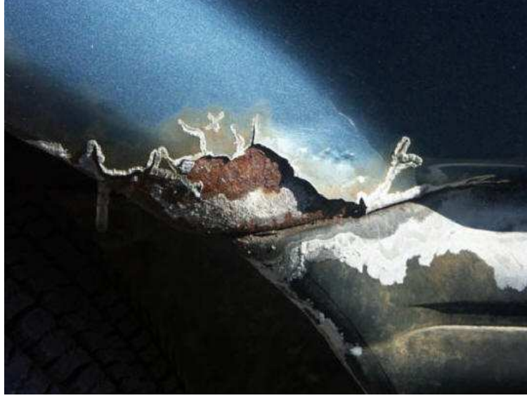
Şekil 2.22 Kaplama bozukluğunun neden olduđu korozyon
