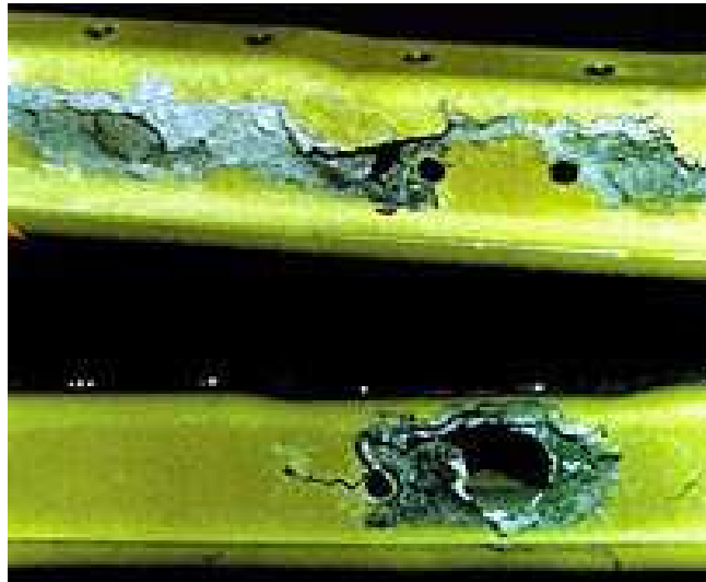
Şekil 2.18 Alüminyum gövde kirişi üzerinde pullanma korozyonu
