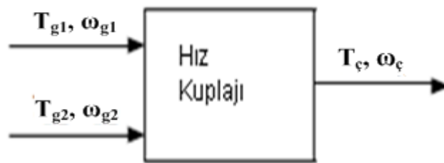
Şekil 3.12 Kavramsal olarak hız kuplajı
