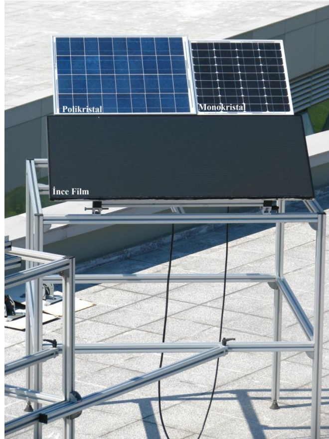
Şekil 4. 2 Farklı teknolojilere ait PV panellerin belli bir açıda konumlandırıldığı plarform
