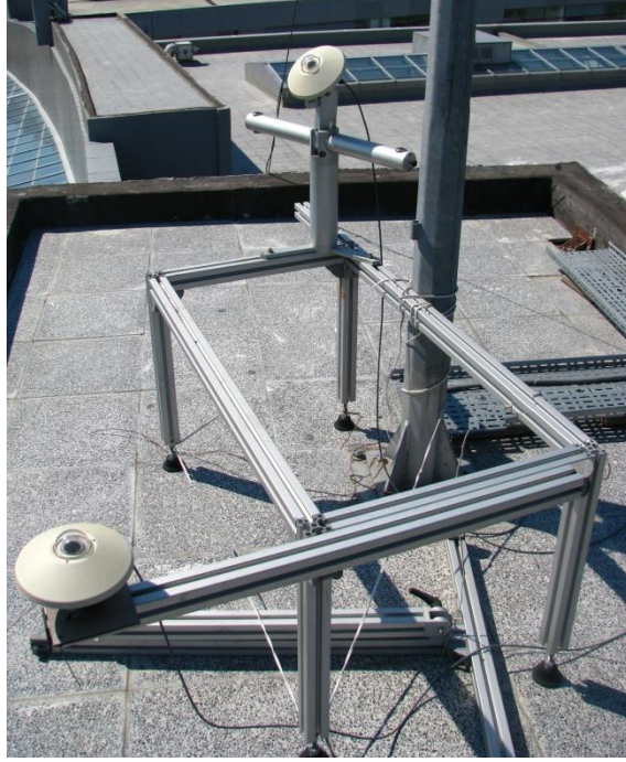
Şekil 4. 3 Yatay ve eğimli yüzeye gelen global ışınımı ölçme düzeneği
