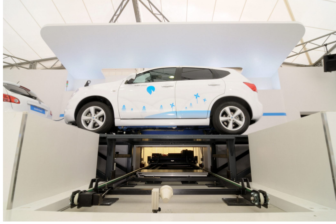
Şekil 2. 17 EA'ların bataryalarının değiştirildiği örnek bir istasyon [73]
