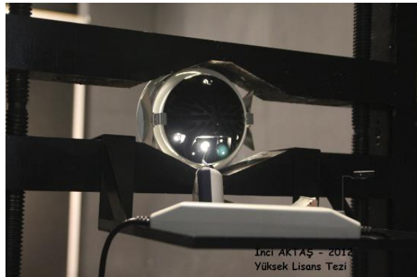
Şekil 4. 10 Işıklığın gonyofotometre cihazındaki konumu
