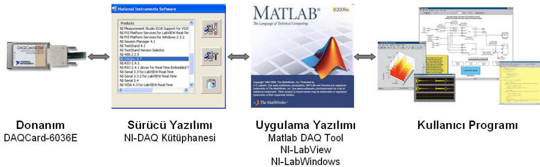
Şekil 5.11 Veri toplama yazılım aşaması
