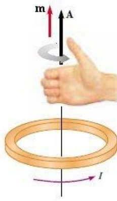
Şekil 2.8 \vec{A} vektörünün yönünün sağ el kuralı ile belirlenmesi[1]
