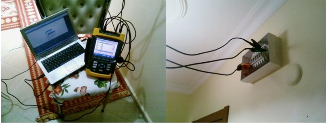
Şekil 3.2 Evsel Yük Verisi Toplama Düzenegi
