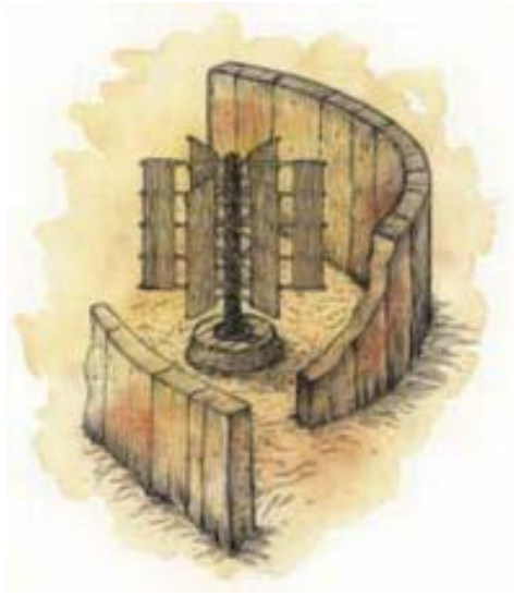
Şekil 2.1 Pers uygarlığında kullanılan bir yel değirmeni [9]
