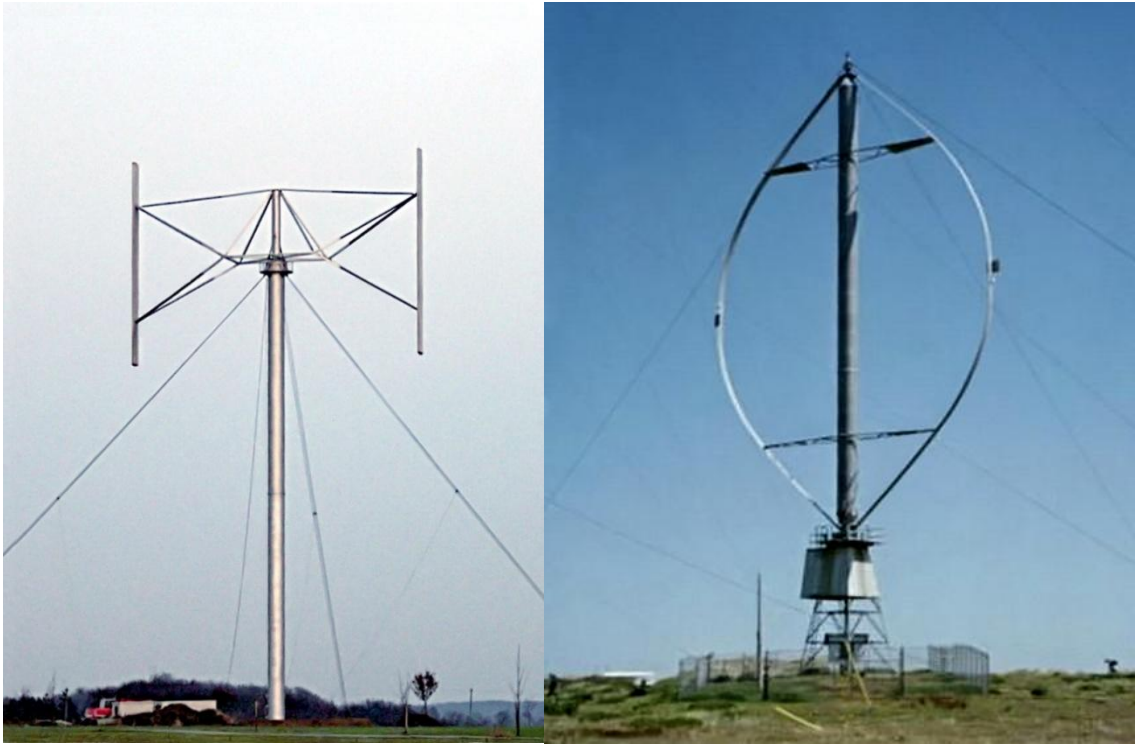
Şekil 2.14 Düz tip bir Darrieus rüzgâr türbini ve Darrieus tipi bir rüzgâr türbini [7]
