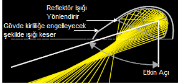
Şekil 4.17 Asimetrik projektörün ışık dağılımına ait görselleştirme (Thorn, 2007)
