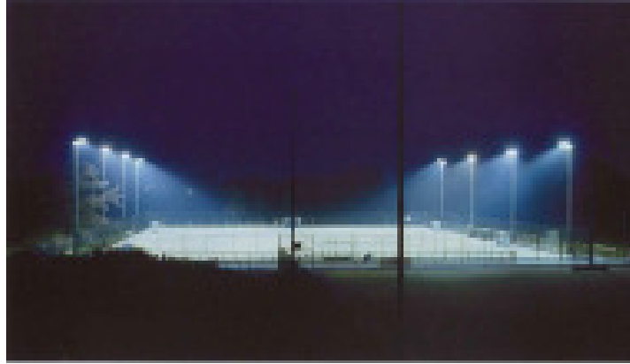
Şekil 4.18 Asimetrik projektörlerle aydınlatılmış saha örneği (Austin, 2000)
