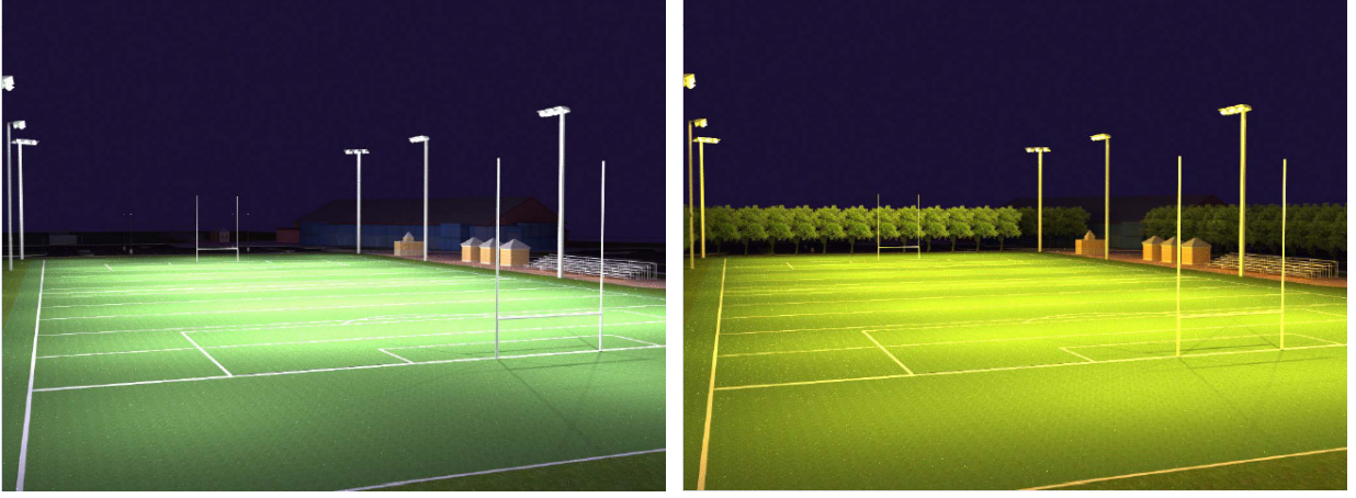
Şekil 3.8 Metal halide ve sodyum ampullü projektörler ile aydınlatması yapılmış Amerikan futbolu sahalarının renksel geriverim açısından farklılığı
