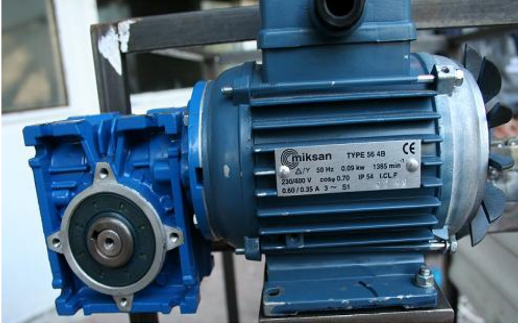
Şekil 5.3 3 Fazlı Redüktörlü Asenkron Motor (0.09 kW, 17 d/d)
