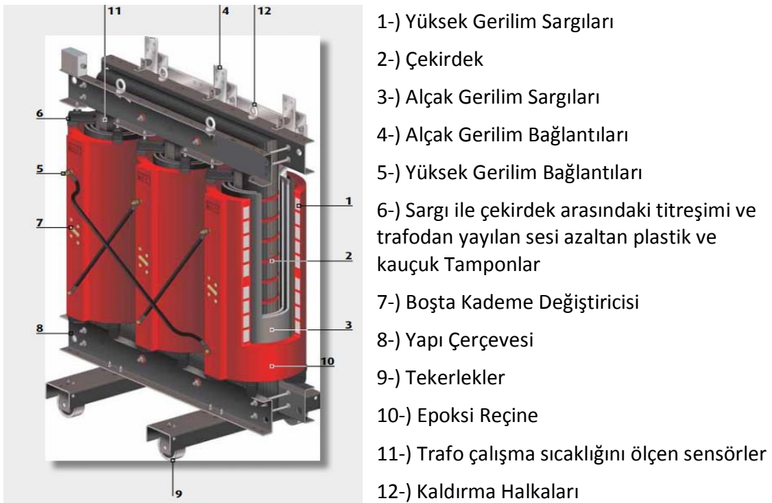
Şekil 2.20 Kuru tip trafo yapısı[29]
