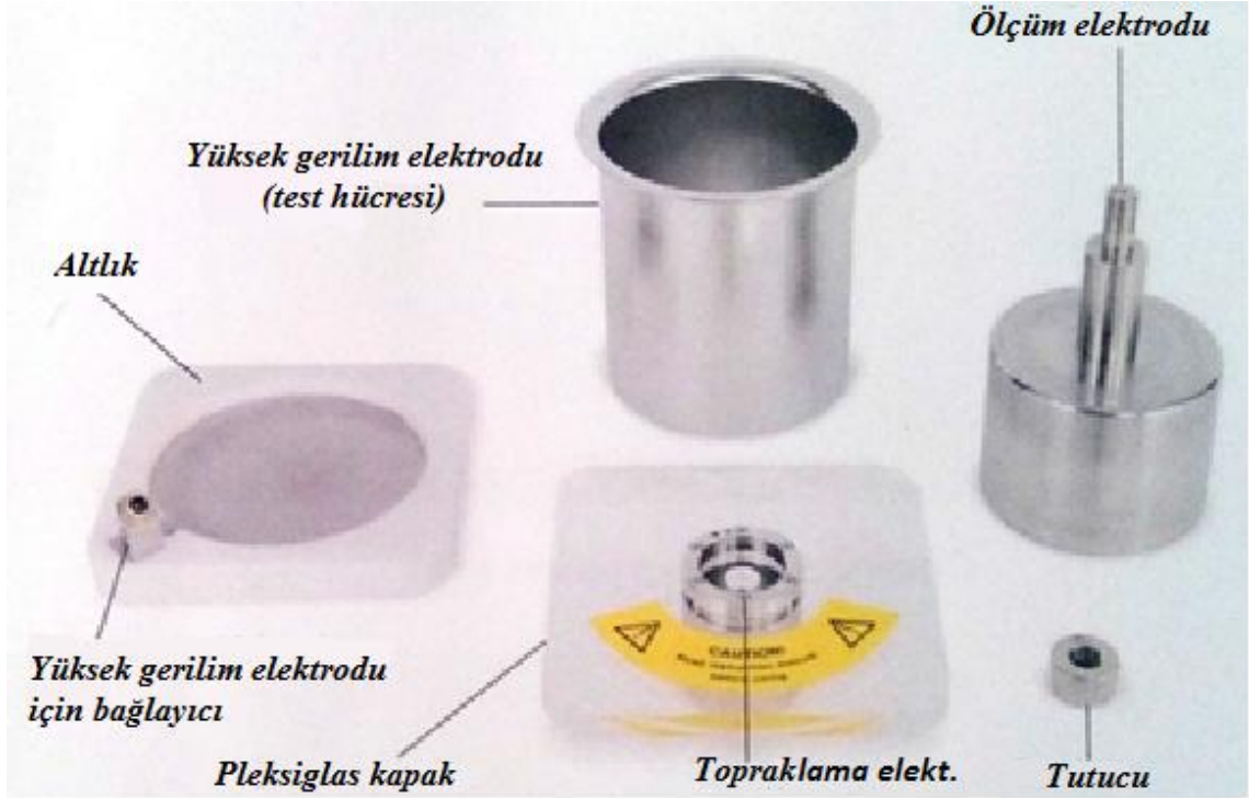
Şekil 5. 7 Tan delta, kapasite ve direnç ölçümleri için test hücresi
