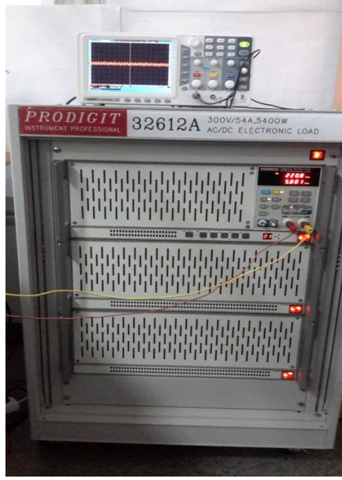
Şekil 5. 12 Akıllı priz kalibrasyonu için kullanılan sistem
