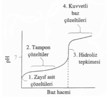
Şekil 6.4 Zayıf asit kuvvetli baz titrasyon eğrisini oluşturulması (Petrucci, 2002).
