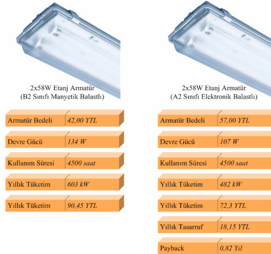
Şekil 3.18 Manyetik balast – elektronik balast enerji tüketim değerlendirmesi-2
