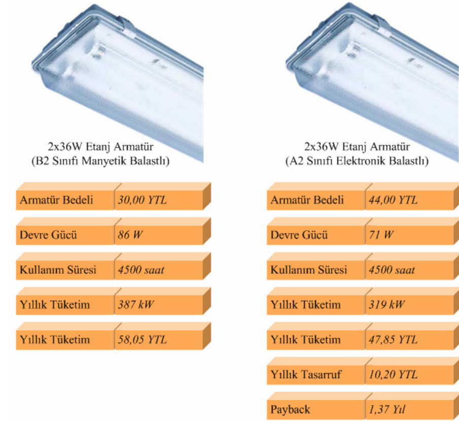
Şekil 3.17 Manyetik balast – elektronik balast enerji tüketim değerlendirmesi
