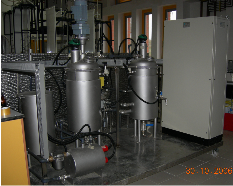
Şekil 3.1 Pilot ölçekli anaerobik atıksu arıtma tesisi
