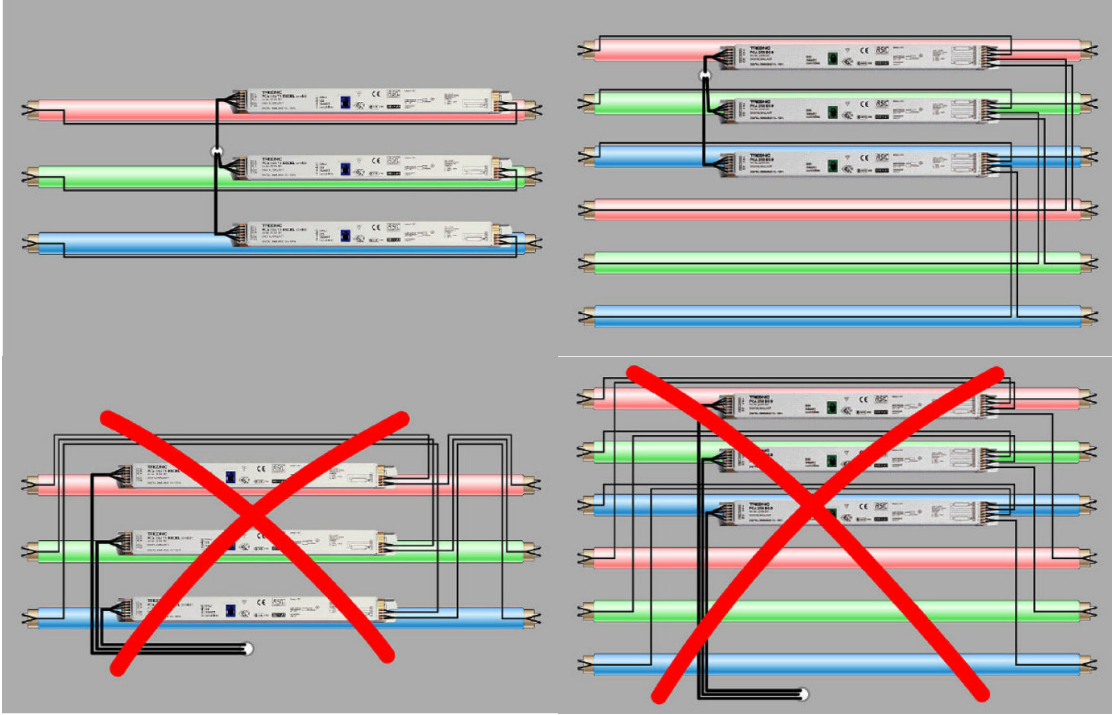
Şekil 8.24 Doğru ve hatalı bağlantılar (Tridonic)
