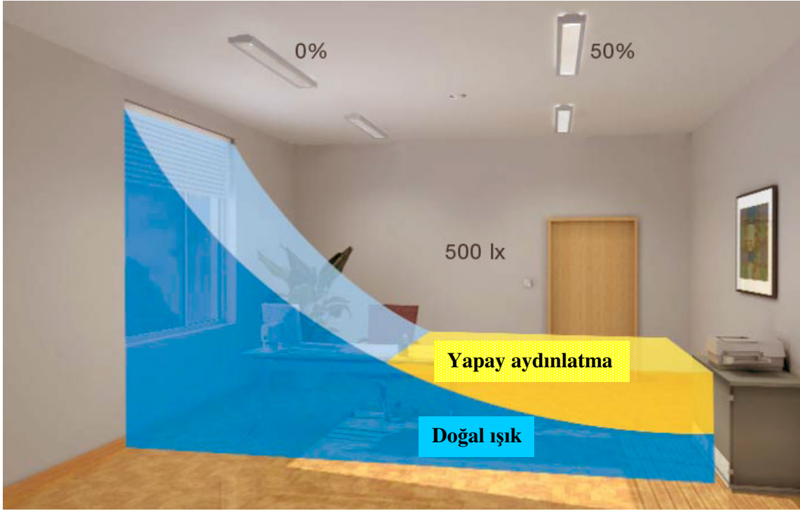
Şekil 9.7 Gün ışığı sensörüne bağlı dimmerleme (Luxmate)
