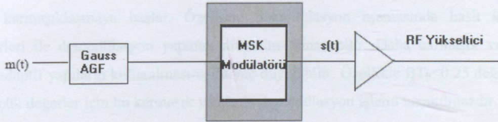
Şekil 4.20 GMSK modülatörü ilkesel şeması
