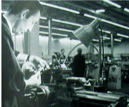
Şekil 5.1 Ek aydınlatmaya örnek (Philips Lighting, 1993).
