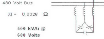
Şekil 7.2 Örnek değerler için filtre konfigürasyonu
