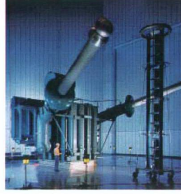
Şekil 4.16 Yağ yalıtımlı yapı Enduktans:270 mH Gerilim: 500 kV DC Akım: 3000 A DC
