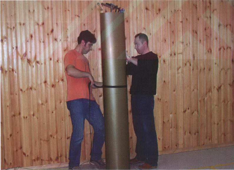
Şekil 4.7 Ekranlama malzemelerinin kaynağa silindirik şekilde sarılması.
