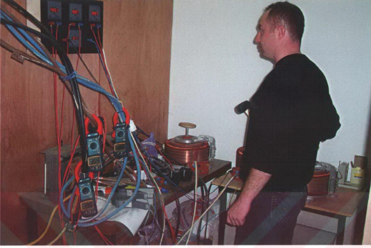
Şekil 4.3 Deney transformatörleri ve varyakların bulunduğu kumanda odası
