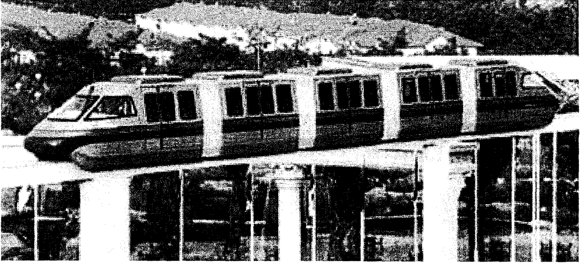
Şekil 4.6 Straddle tipi havaray sistemi.
