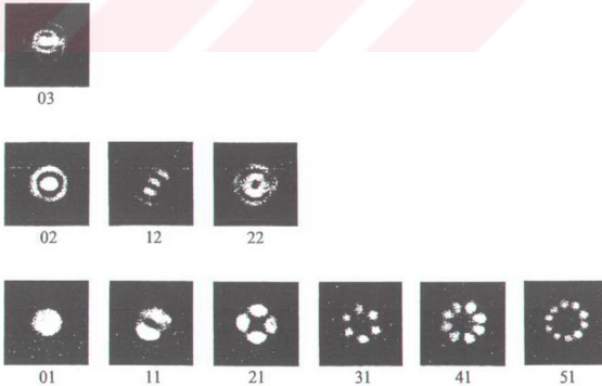
Şekil 2.9 Bir optik dalga kılavuzunun ilk on modu LP_{\nu\mu} (Stolen, R. H. , ve Leibolt, W. N. : Uyarılan dört foton karışımı kullanan optik fiber modlar. Appl. Opt., 15, 1976, 239-243)
