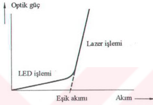
Şekil 12.6 Bir lazer diyodunun ışık-akım karakteristiği
