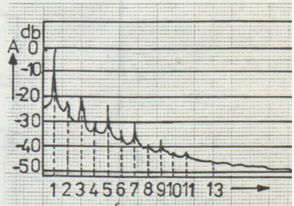
Şekil 3.6. Ark fırınlarında bağıl harmonik akımının sürekli spektrumu.
