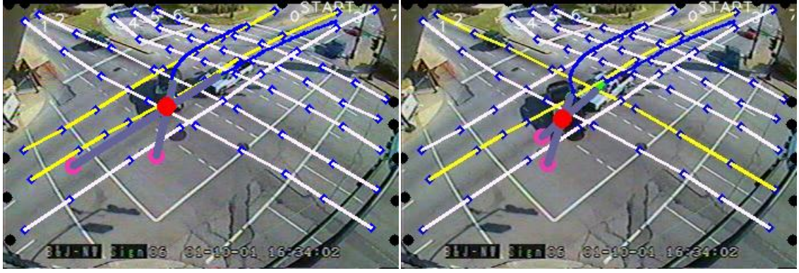
Şekil 5.18 Aracın yanlış yönde dönüşü sebebiyle kaza durumunun gelişimi
