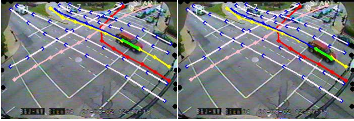
Şekil 5.7 Genel yol modellerinin kesişim noktasında sınıflandırma başarısı
