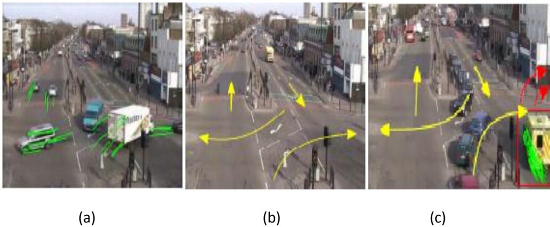
Şekil 1.2 Parçacık tabanlı yörünge analizine dayalı aykırı davranış belirleme [10] (a) Araçlara ait yörüngelerin elde edilmesi (b) Hareket modellerinin elde edilmesi (c) Aykırı davranışlardaki araçların tespiti
