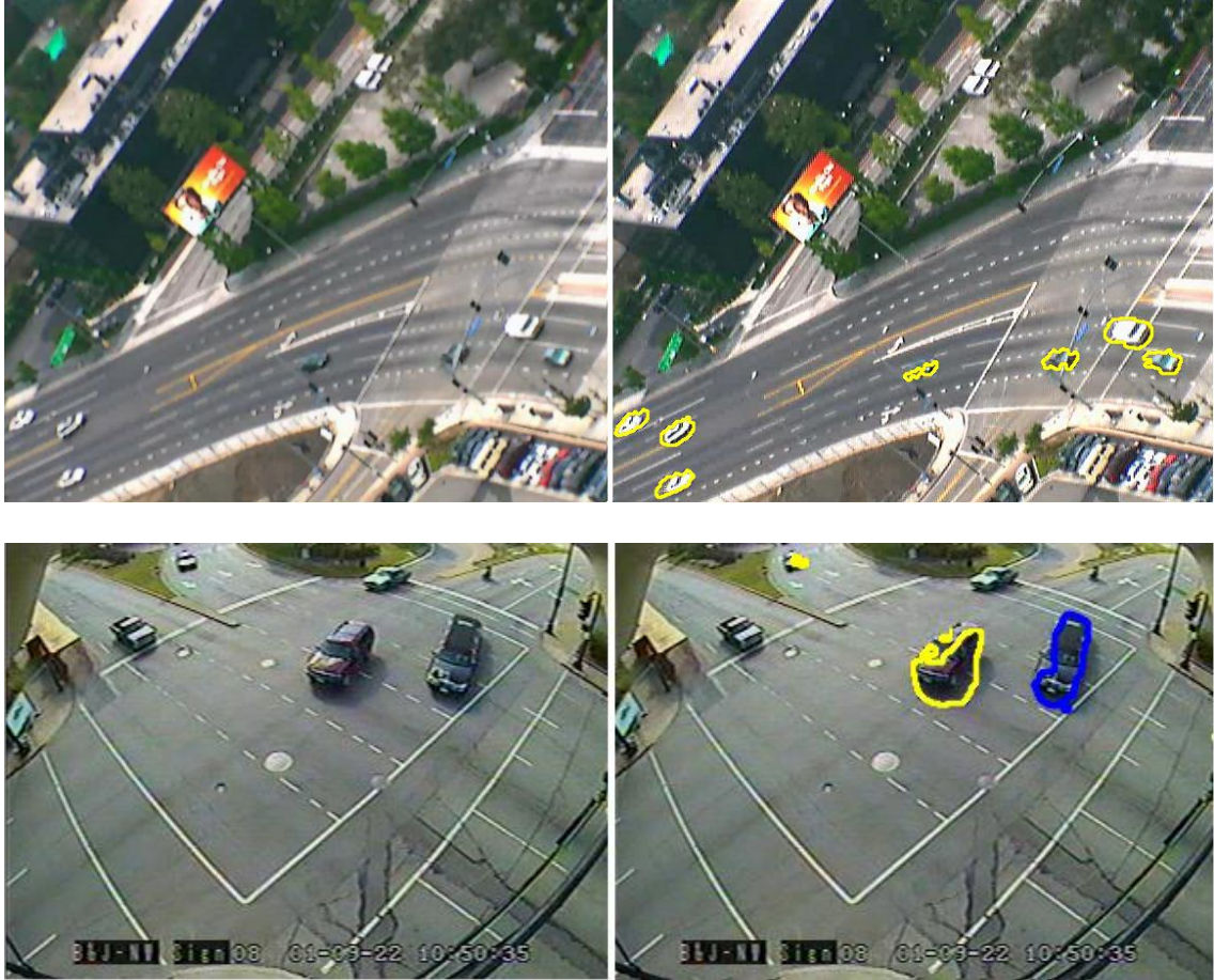
Şekil 3.5 Bağlı bileşenler analizi ve çevrit belirleme işlemi ile araçların belirlenmesi
