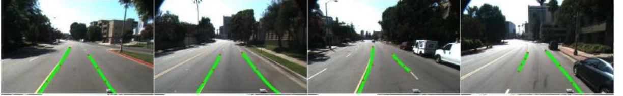
Şekil 1.7 (Aly, 2008) 'deki çalışmanın örnek şerit tespit sonuçları
