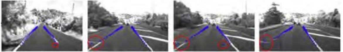
Şekil 1.6 (Jiang vd., 2009b)’de tespit edilen şerit üzerindeki yanlış noktalar.
