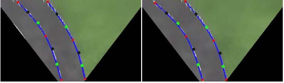
Şekil 3.16 Yirmişer ardışık altı görüntünün Bezier eğri modeli sonuçları
