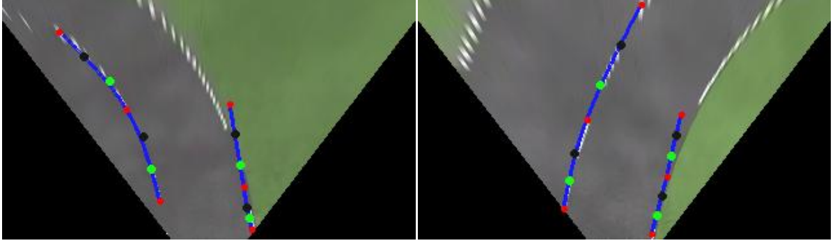
Şekil 3.65 Karmaşık test videosundaki başarısız şerit tespit sonuçlarından bazıları
