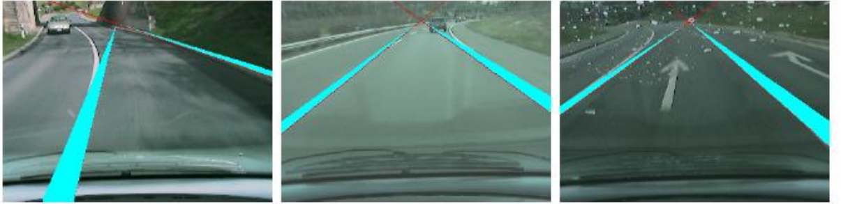
Şekil 2.31 (Macek vd.,2004)' deki virajlı yolda düz şerit tespit sonucu
