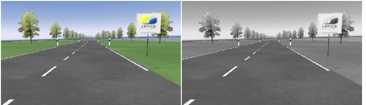
Şekil 2.4 (a) RGB renk uzayındaki görüntü. (b) Gri seviyeli görüntü.
