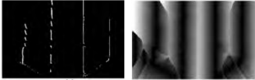
Şekil 1.4 (Jiang vd., 2009b)’deki çalışmanın (a) Kenar belirleme sonucu (b) Mesafe dönüşümü sonucu.
