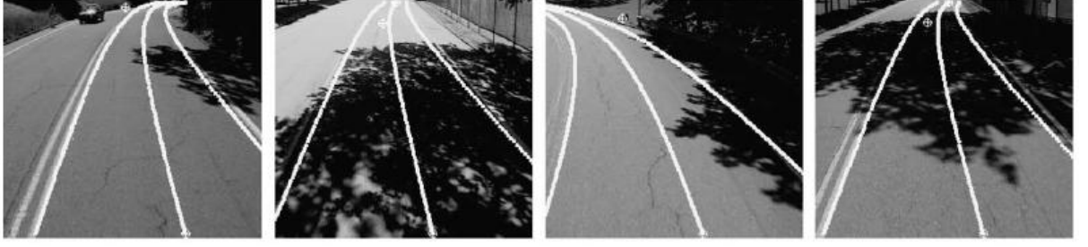
Şekil 1.3 (Wang vd., 2004) Örnek başarılı şerit tespit sonuçları
