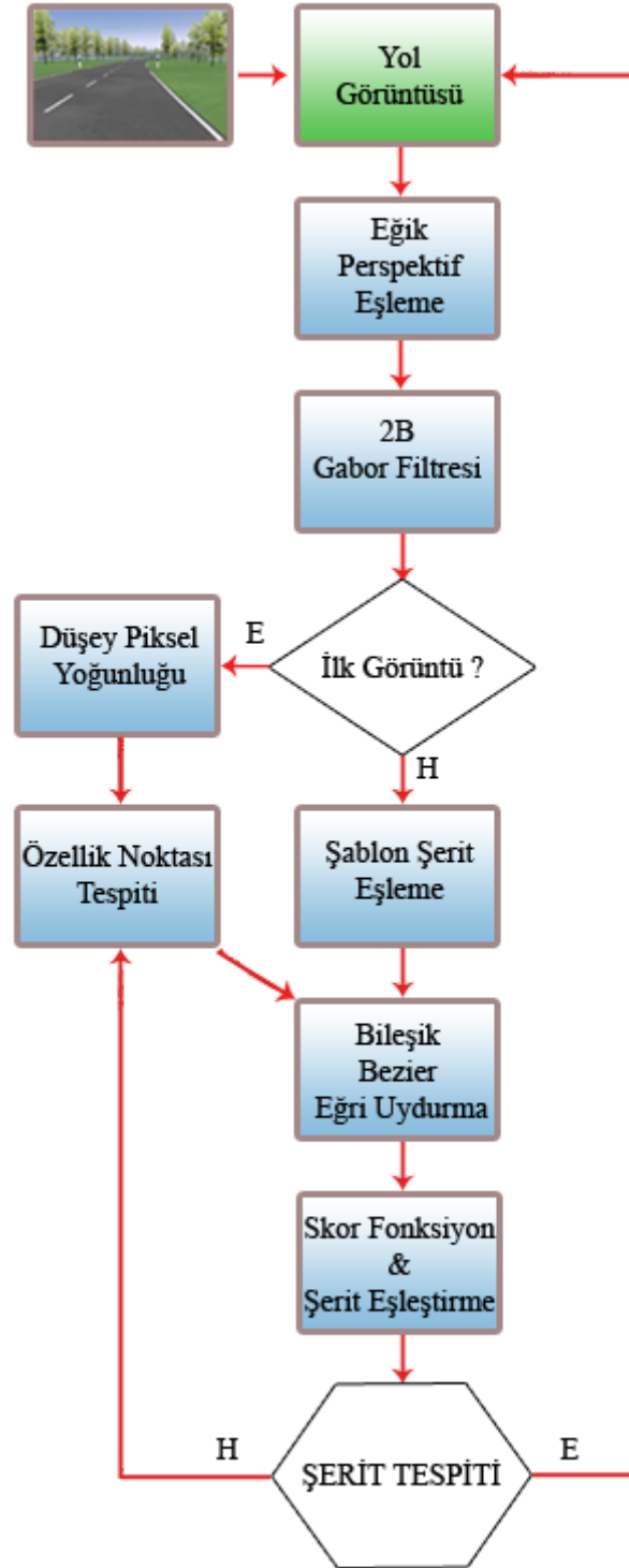
Şekil 2.2 Şerit Tanıma ve Takip Sistemi Blok Diyagramı
