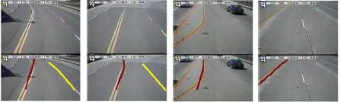
Şekil 1.2 (Kim, 2008) çalışmasına ait Örnek Başarısız Şerit Tespit Sonuçları
