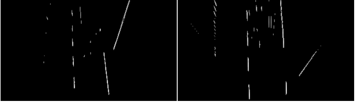
Şekil 3.72 Belirli aralıklarla ardışık dört kuş bakışı görüntünün Gabor ve eşiklenmiş hali
