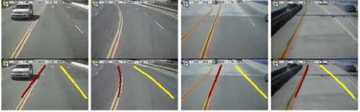
Şekil 1.1 (Kim, 2008) çalışmasına ait örnek başarılı şerit tespit sonuçları
