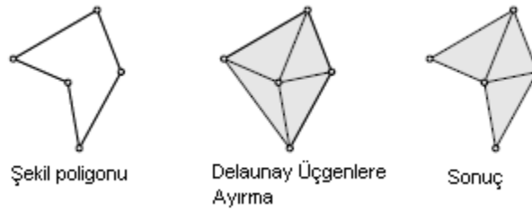
Şekil 4-1 Delaunay üçgenlere ayırma metodundan sonra oluşan istenmeyen üçgenlerin yok edilmesi
