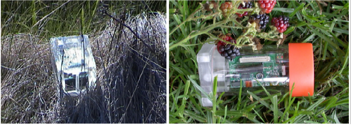
Şekil 3.2 Great Duck Island Projesinde kullanılan koruyucu kılıf içindeki telsiz algılayıcı düğümler (Mainwaring, Polastre, Szewczyk, Culler, Anderson, 2002)
