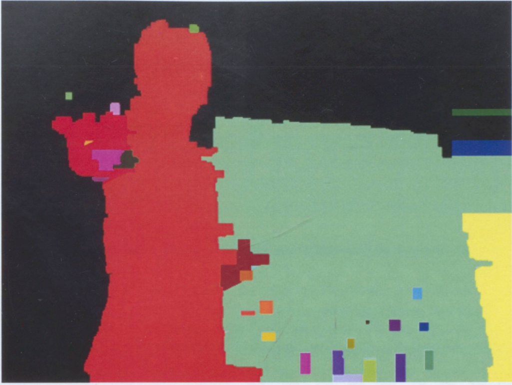
Şekil 3.24 Stereo uzaklık haritasının bağlı bileşen analizi ile bölütlenmesi sonucu elde edilen etiketlenmiş görüntü
