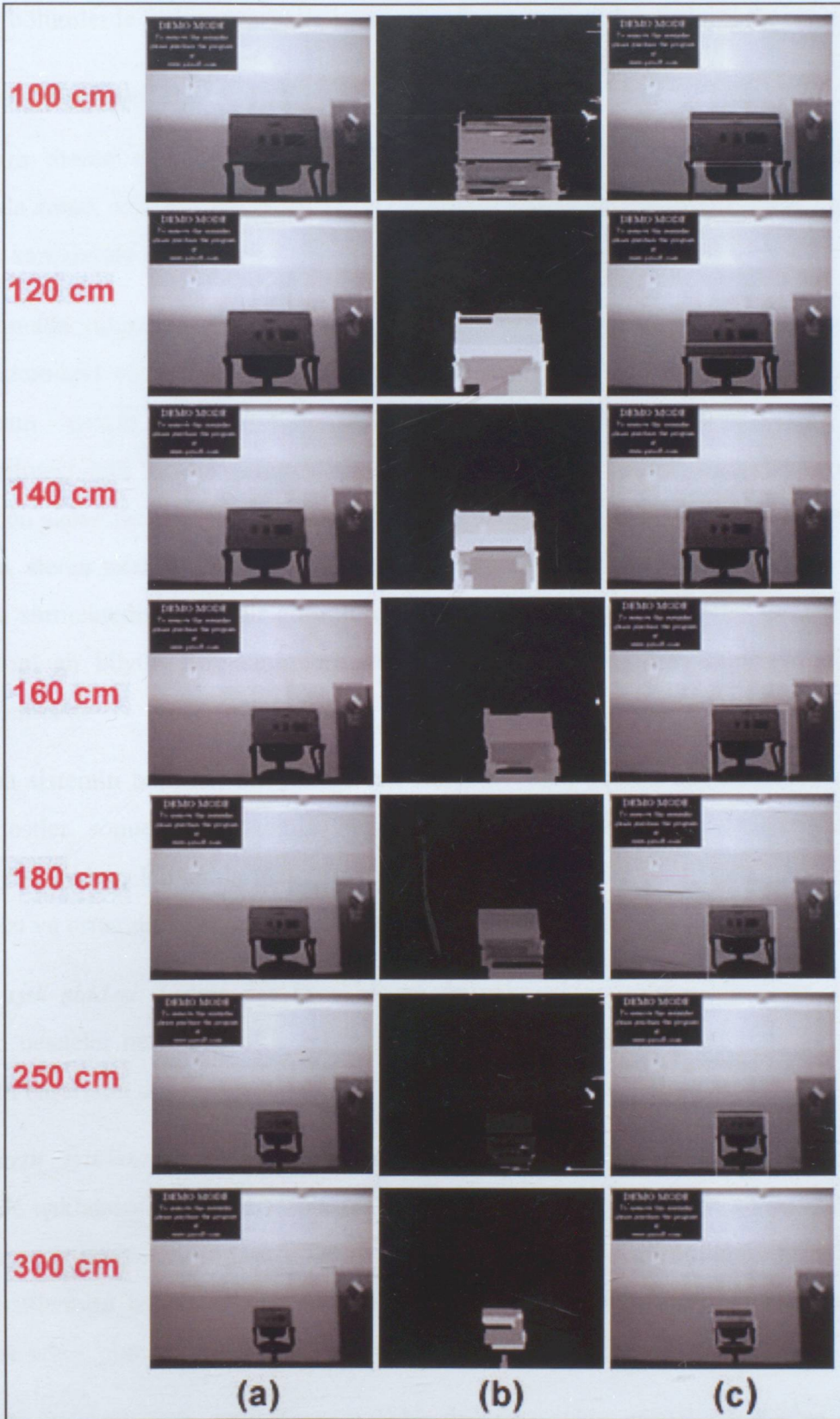
Şekil 4.5 (a) Orjinal sol resim (b) Stereo uzaklık haritası (c) Engel olarak tespit edilen bölgeler
