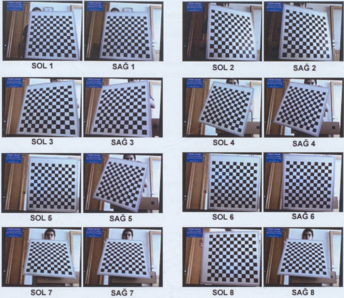
Şekil 3.4 Şekil 3.2'deki görüntülerin rektifikasyon sonucu elde edilen görüntüleri
