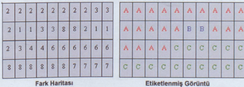
Şekil 3.21 Küçük bir stereo uzaklık haritası için elde edilmiş etiketlenmiş görüntü
