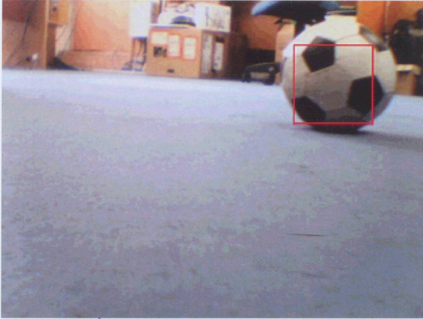
Şekil 3.6 Futbol topunun Mean-Shift yöntemi ile bulunması
