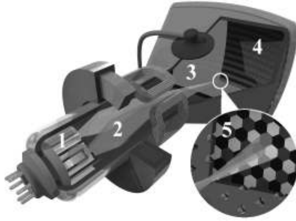
Şekil 2.4 Renkli katot ışını tüpünün kesit resmi (Resimdeki sayılar şu bölümleri belirtmektedir: 1. Elektron tabancası 2. Elektron ışını 3. Görüntülenen resmin kırmızı, yeşil ve mavi bileşenleri için ışınları ayırıcı maske 4. Kırmızı, yeşil ve mavi bölgelere sahip fosfor tabaka 5. Ekranın fosfor kaplı iç kısmının yakından görünümü)
