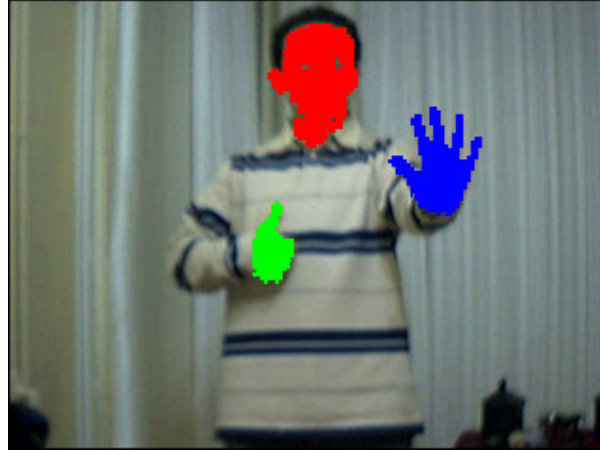
Şekil 4.9 CCL algoritması ile ten rengi olan piksellerden ellerin ve yüzün bulunması
