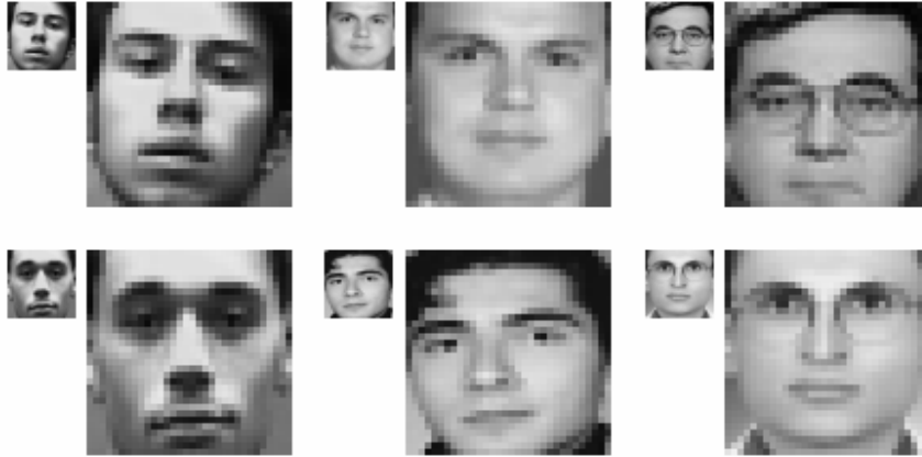
Şekil 7.3 Yüz tanıma alt sistemini tarafından oluşturulan kanonik yüz modelleri (32x32 normal boyutlarında ve 3 kat büyültüş 96x96 boyutlarında)
