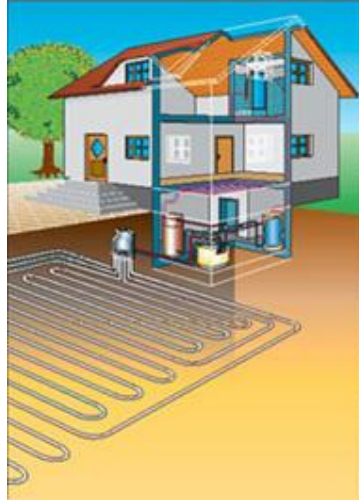
Şekil 5.2: Yatay Kolektörlü Isı Pompası Sistemi
