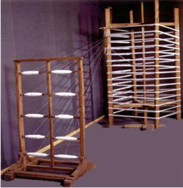
Fotoğraf 7. Dokumacılıkta Dördüncü Aşama Dokumaya Hazırlık ve Kullanılan Ahşap Düzenekler
