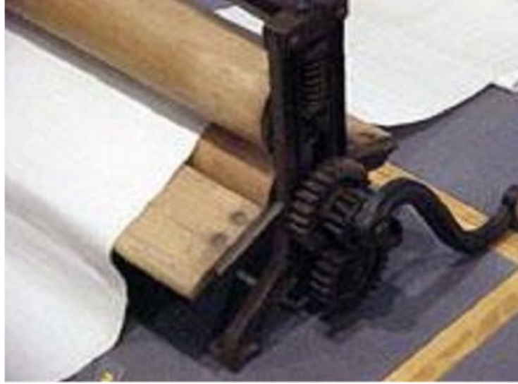
Fotoğraf 10a. Dokumacılıkta Altıncı Aşama Dokumadan Sonra Yapılan Düzleme İşleminde Kullanılan Ahşap Düzenek
