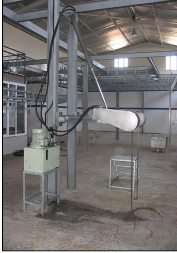
Şekil 5.7 Modern Mezbahalarda Bulunan Deri Yüzme Ekipmanı
