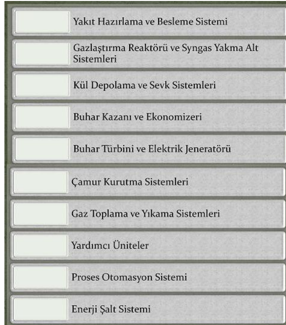
Şekil 5.21 Kesimhanede Oluşan Katı Atıkların Gazlaştırılmasında Kullanılması Gereken Üniteler (Tolay M.,2008)
