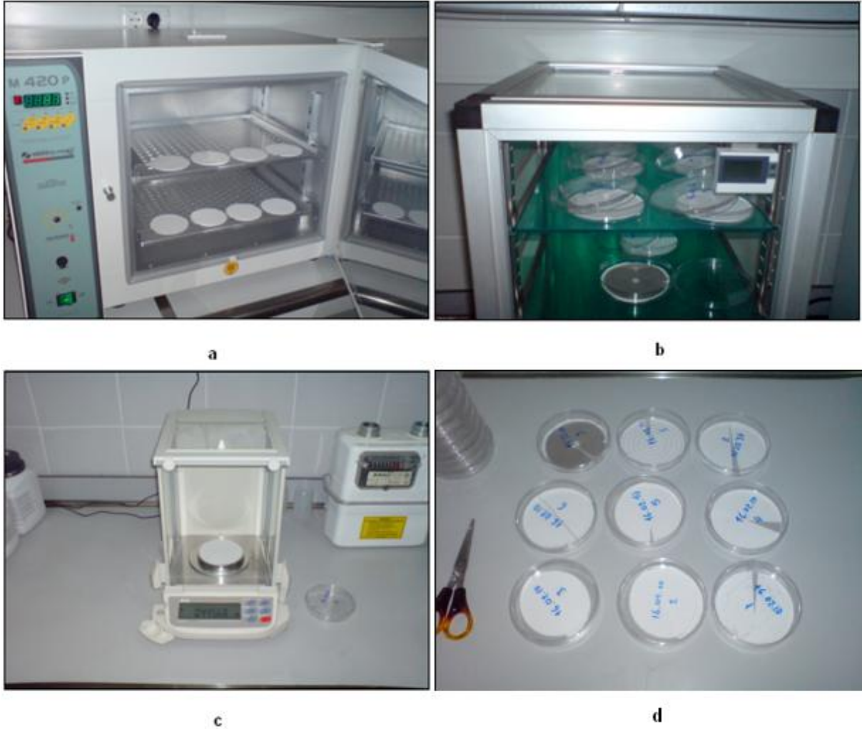
Şekil 4.4 a. Filtrelerin desikatörde kurutulma işlemi b. Filtrelerin desikatörde şartlanma işlemi c. Filtrelerin tartım işlemi d. Filtrelerin ikiye ayrılma işlemi
