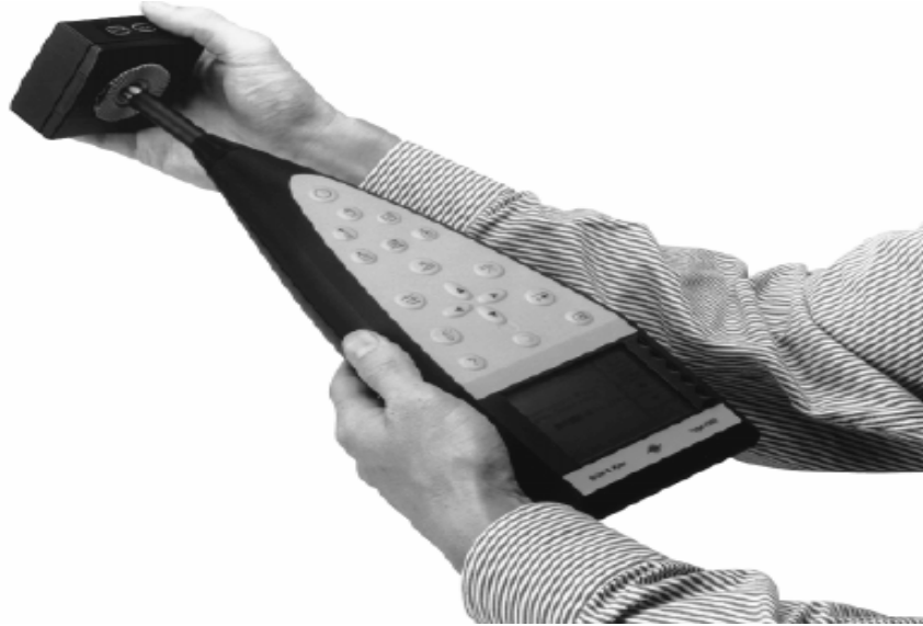
Şekil 3.1 Gürültü düzeyi ölçüm cihazı ve kalibratörü.( B&K, 2007)
