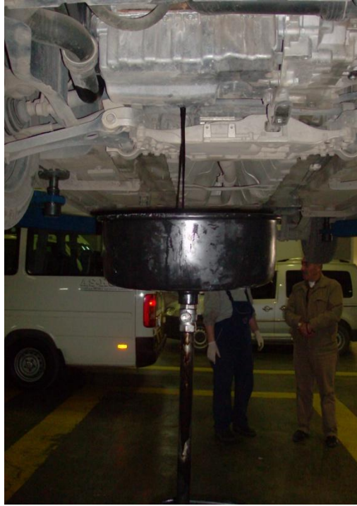
Şekil 3.3. Atık yağın araçtan çıkarılması
