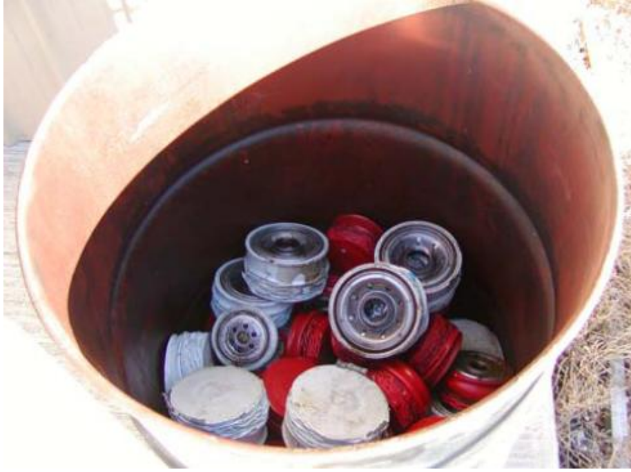
Şekil 4.15 Sıkıştırılmış atık filtreler
