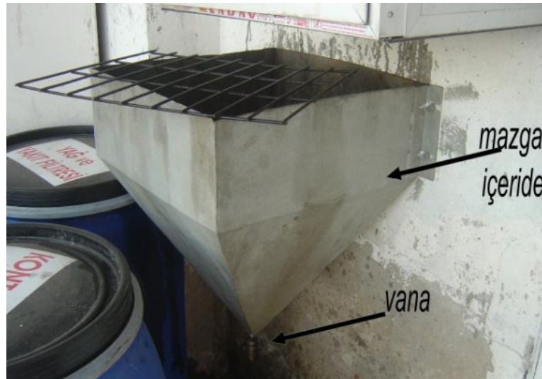
Şekil 4.4. Atık filtreden atık yağı çıkarma amaçlı kullanılan süzgeç
