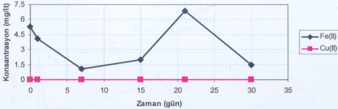
Şekil 5.14 5 ppm \text{Fe}^{+2} dozlanan reaktörde (R1) 30 günlük periyotta, su fazında \text{Fe}^{+2} ve \text{Cu}^{+2} metallerinin değişimi
