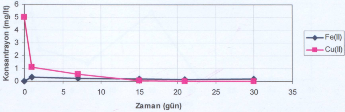
Şekil 5.16 5 ppm \text{Cu}^{+2} dozlanan reaktörde (R2) 30 günlük periyotta, su fazında, Fe ve Cu metallerinin değişimi
