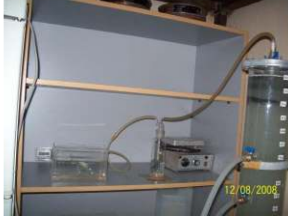
Ahşap ünitadaki su kapaını, gaz sayacın görünüşü
