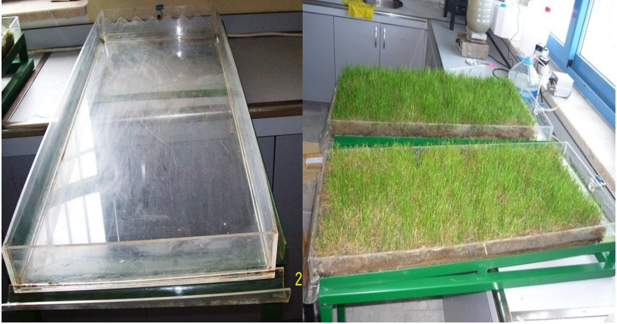
Şekil 3.5 Laboratuvar ölçekli küçük boyutlu YADA sistemi
