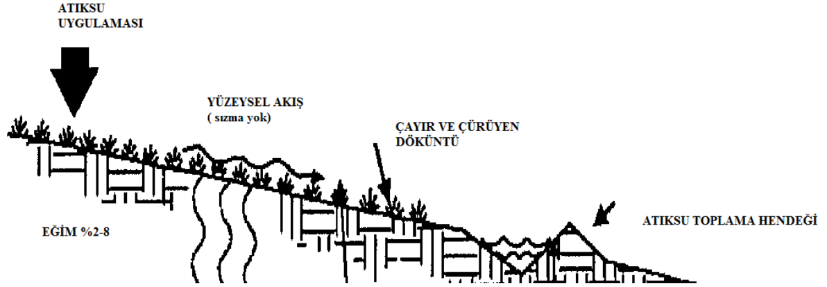
Şekil 2.1 Yüzeysel akışlı sistemler (Samsunlu, 2006)
