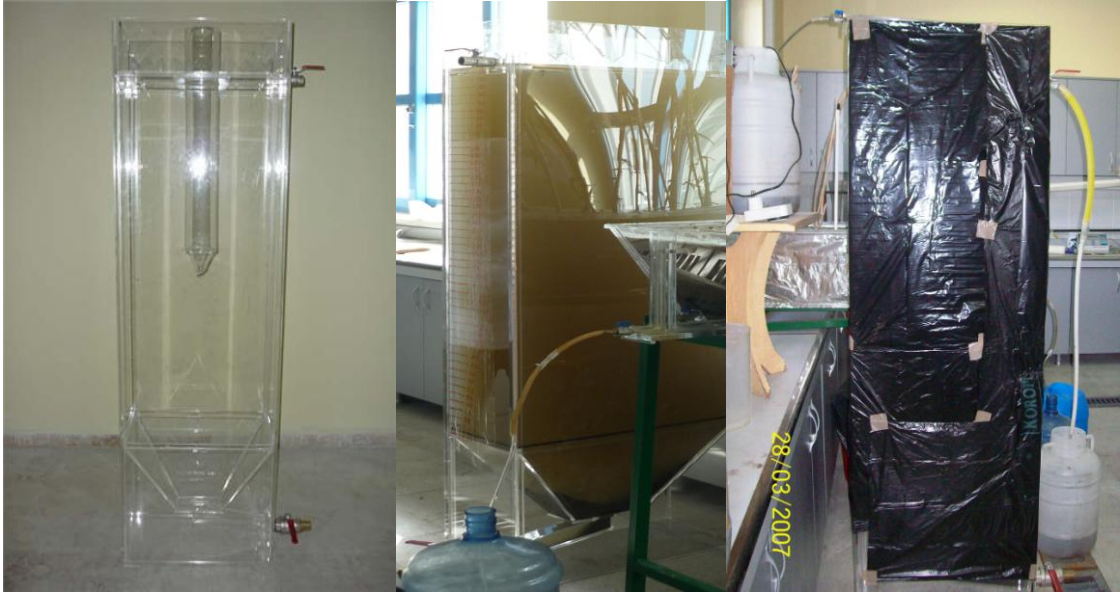
Şekil 3.4 Laboratuvar ölçekli Imhoff Tankı
