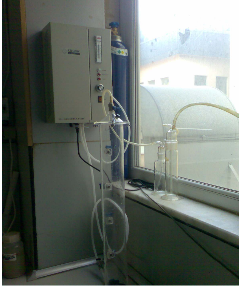
Şekil 5.2 Ozon düzeneğinin deney öncesi görünümü (AZCO marka VMUS-4 model)
