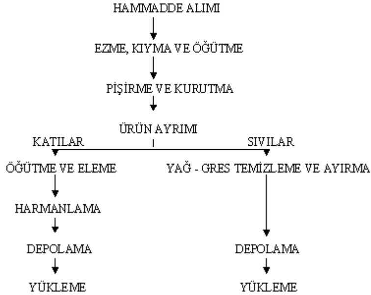
Şekil 2.2 Rendering işlemi üretim düzeni (Gönenç, 1984)
