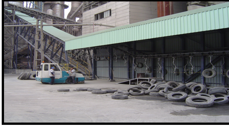
Şekil 6.8 Atık lastiklerin otomosyonla fırına beslenişi Akçansa A.Ş.
