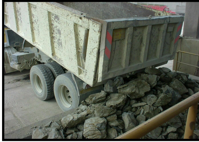
Şekil 2.4 Taş ocaklarından gelen ham maddelerin öğütücüye verilişi (Akçansa A.Ş. )
