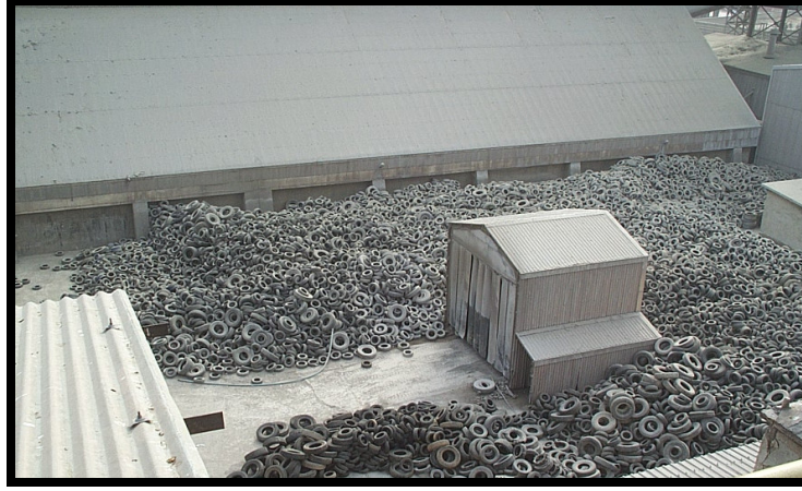
Şekil 3.1 Çimento fabrikasında atık lastiklerin depolanışı (Akçansa A.Ş)
