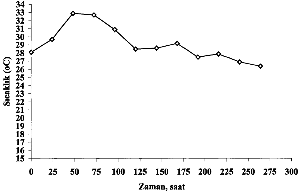
Şekil 7.20. S 2 Nolu numunede Dewar Kabı Sıcaklık Testi
