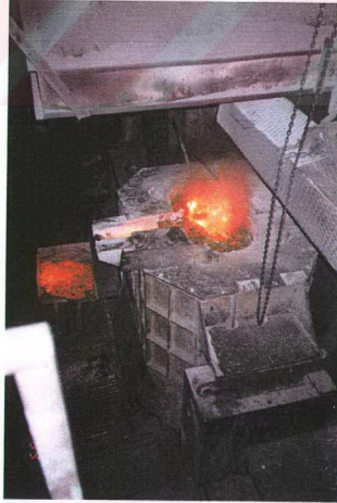
Şekil 5.2 Bir endüksiyon ocağında yapılan pik demir ergime işlemi
