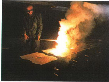
Şekil 5.4 Ergimiş metalin kalıplara dökme işlemi
