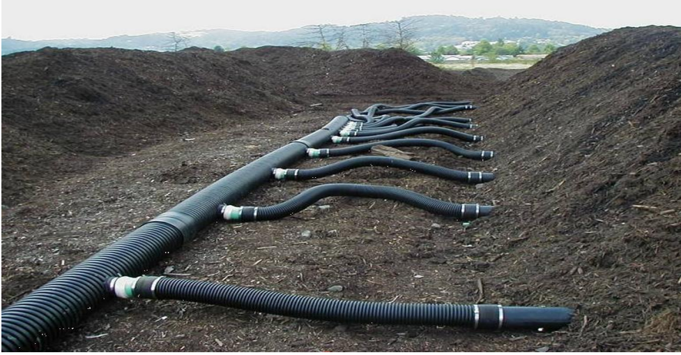
Şekil 3.10 Havalandırmalı statik yiğın kompostlaştırma prosesi uygulama örneği
